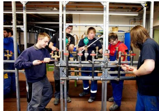
Hier werden Verteilergruppen aus „schwarzem Rohr“ aufgebaut. Foto: Kaps
